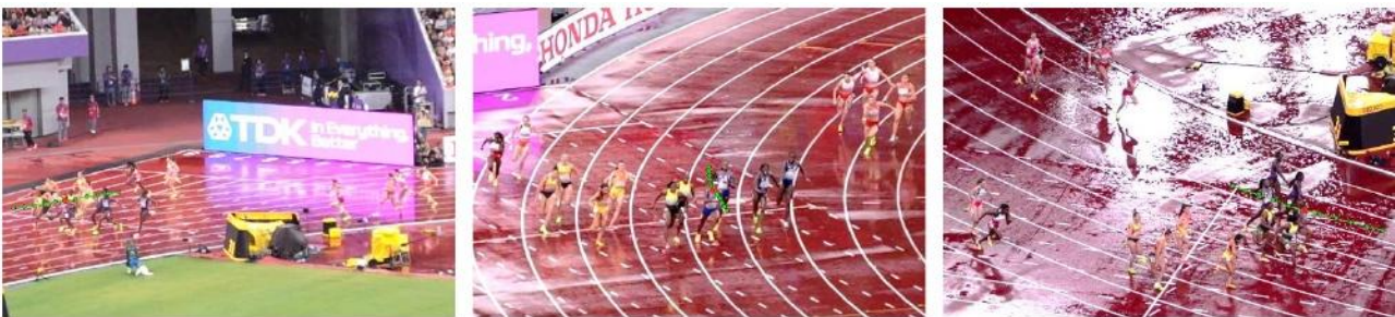
图 2.来自同步多摄像头视频的运动员位置三维重建。对于有代表性的运动员，估计的躯干上缘位置(红圈)及其在 ±0.25 s 内的轨迹(绿线和圆圈)被覆盖在每个摄像机视图上。
